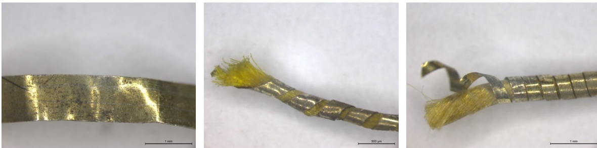
Figs. 103, 104 e 105 – Fotografias das amostras M20, M23 (ambas em prata dourada) e M10 (liga de prata dourada), obtidas ao microscópio estereoscópico (20x, 50x, 32x, respetivamente). © Joana Palmeirão
