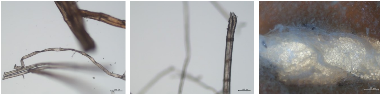
Figs. 295, 296 e 297 – Da esquerda para a direita: imagens da secção longitudinal da amostra For15.2 e imagem da secção transversal da amostra For19, nas quais se identificam as fibras de algodão e linho/cânhamo. © Joana Palmeirão
