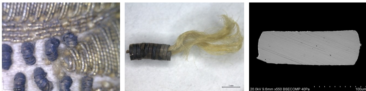
Figs. 155, 156 e 157 – Da esquerda para a direita: imagens do bordado a ouro do vestido onde se observa a aplicação de canotilhos e da amostra do canotilho (V16), obtidas por Dino-Lite e por microscopia estereoscópica (20x), e imagem SEM (BSE) da mesma amostra, na qual é visível o douramento a toda a volta (técnica cast, drawn and rolled ). © Margarida Nunes e Joana Palmeirão
