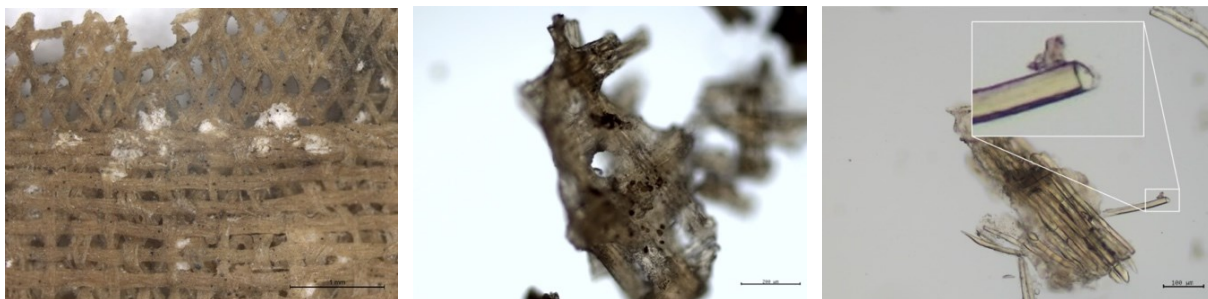
Figs. 300, 301 e 302 – Da esquerda para a direita: imagem da amostra For2 (rosto) obtida ao microscópio estereoscópico (32x) e imagens da secção longitudinal obtidas ao microscópio de campo claro (100x e 200x), nas quais se identificam as fibras de seda. © Joana Palmeirão
